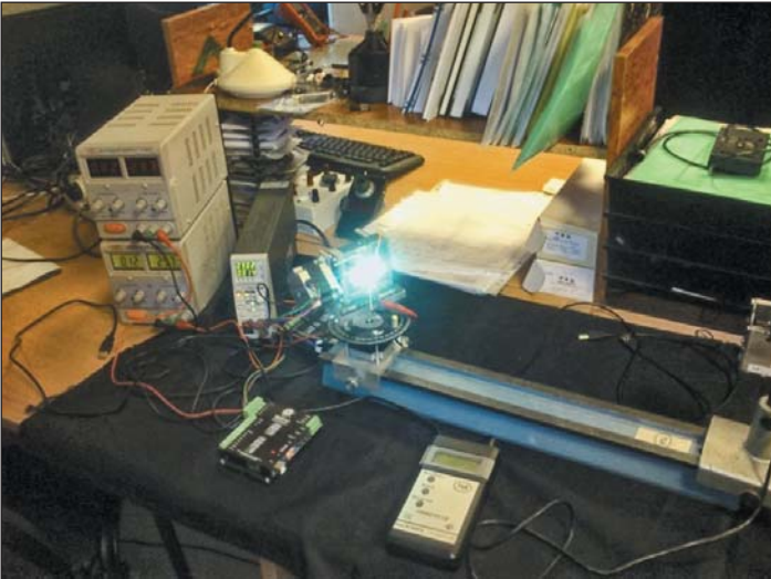
Рис. 2. Макет гониометрического комплекса на основе шаговых двигателей с результирующими данными
