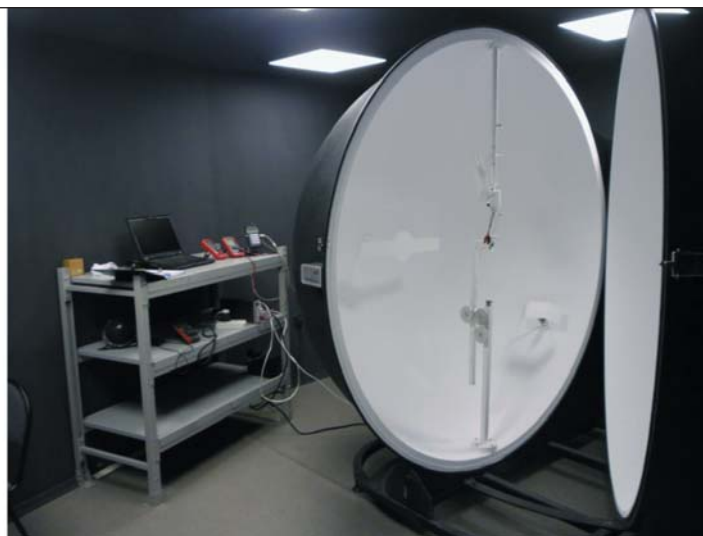
Рис. 1. Фотометрические комплексы на основе интегрирующей сферы, изготовленные в ООО «НТП «ТКА», диаметрами 1 и 2 м
